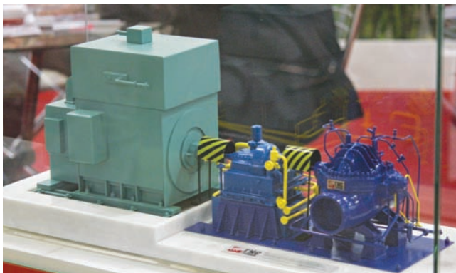
Макет агрегата электронасосного нефтяного магистрального АНМ 7000-250-3 для трубопроводной системы ВСТО-2
